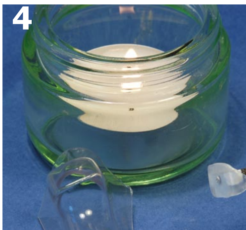
4. Všetky číre diely nahradené – bočné okná vyrezané z tenkej fólie, čelný štítok „vytiahnutý“ na kopyte upravenom z pôvodného štítku
