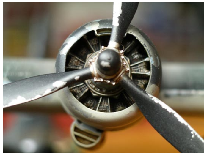
Na kov olietaná vrtuľa pomocou strhávania farby páskou.
